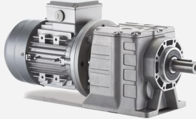
La serie dei riduttori a ingranaggi tipo RD, costruita con carcassa fusa in unico pezzo e con supporto interno per alloggiare 2 o 3 coppie di ingranaggi, è costruita secondo le norme di progettazione ISO e con l'ausilio di programma di analisi strutturale per verifica della deformata e dello stress.
