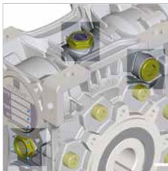
Смазка уже предоставляется Motive с долговечным синтетическим маслом до размера BOX 90 и с минеральным маслом от размера BOX 110. Передаточное устройство оснащено полным набором наполнителей, уровневых и воздухозаборных пробок, позволяя устанавливать во все монтажные позиции и облегчать управление запасами.
